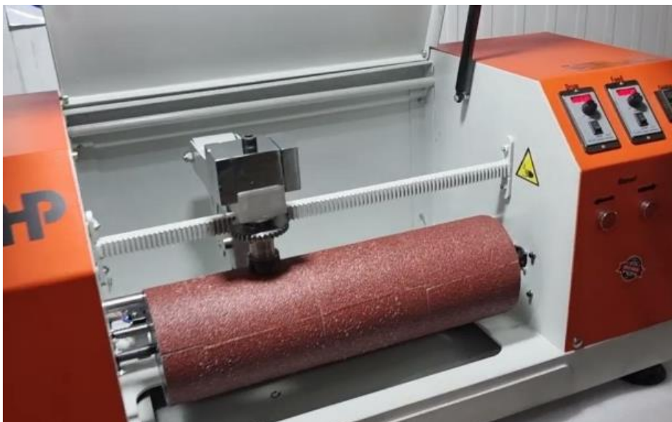
Zařízení pro stanovení odolnosti vůči oděru pryže (ISO 4649)
